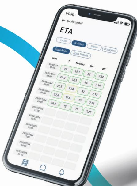
A aplicação é desenvolvida em um **software SCADA**, porém conta com a possibilidade de realizar integração com aplicação **web**, sendo utilizada por meio de um computador ou dispositivo móvel provido de um navegador web atualizado com acesso a internet.
