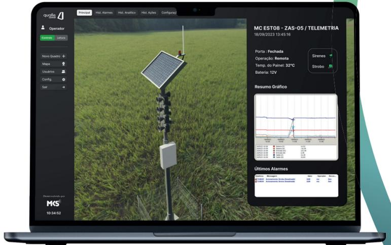
Além disso, conta com sistema de alimentação fotovoltaica off grid, com capacidade de autonomia dimensionado para operar no mínimo com **05 dias sem necessitar de luz solar**.
